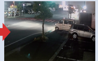
※低照度時は光源増幅の為、カラーノイズが発生します
